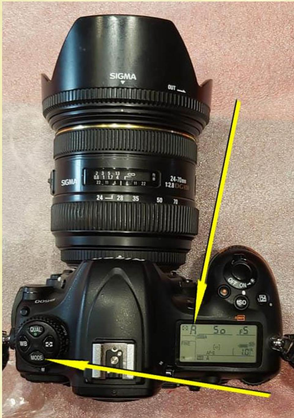
Sur les nikon pros, on appuie sur « mode » sur le trefle à gauche, puis on tourne la molette pour choisir dans la série « P S A M » le mode qui nous convient et qui s'affiche dans le viseur et sur l'écran.
